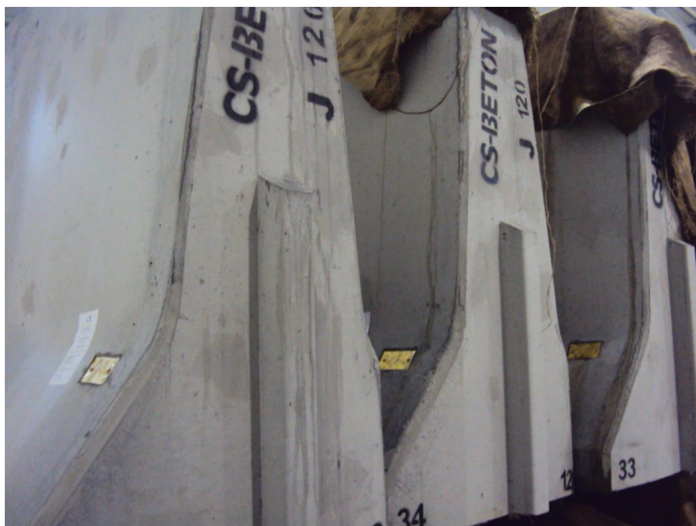
Obrázok 15 – Značenie farbou na jednom čele každého dielca
